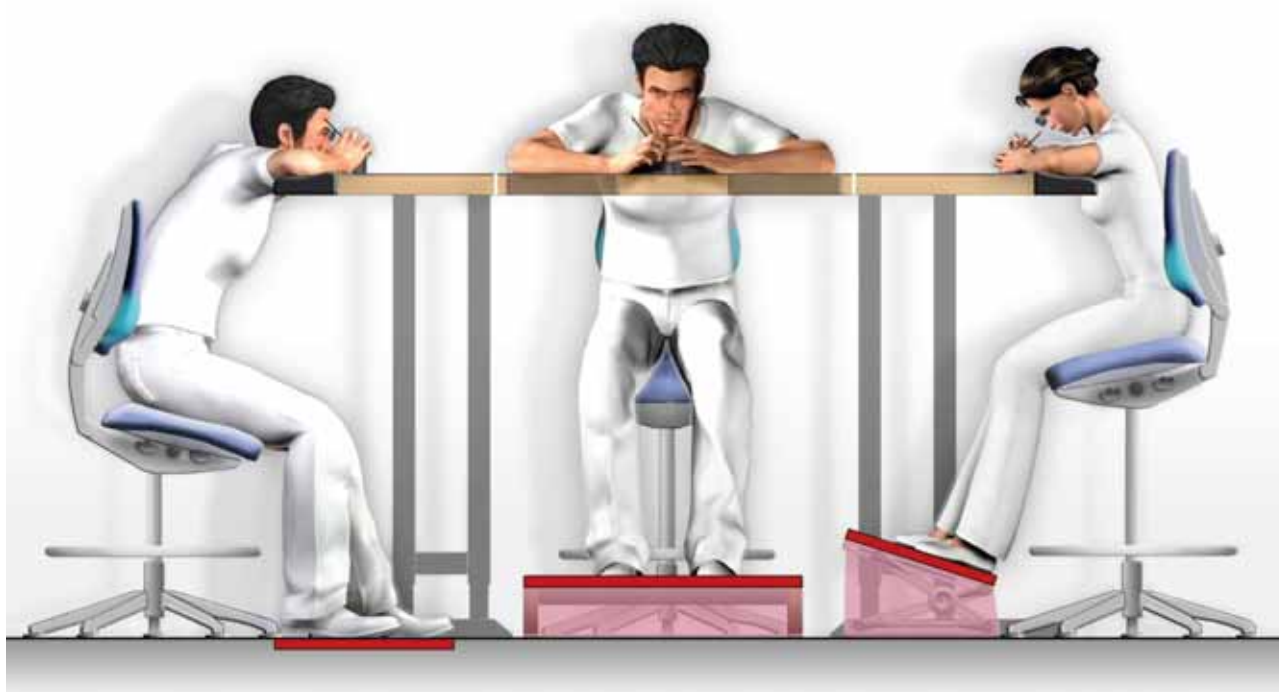
Figura 7: possibilità di adattare l'altezza ai i banchi di lavoro fissi
